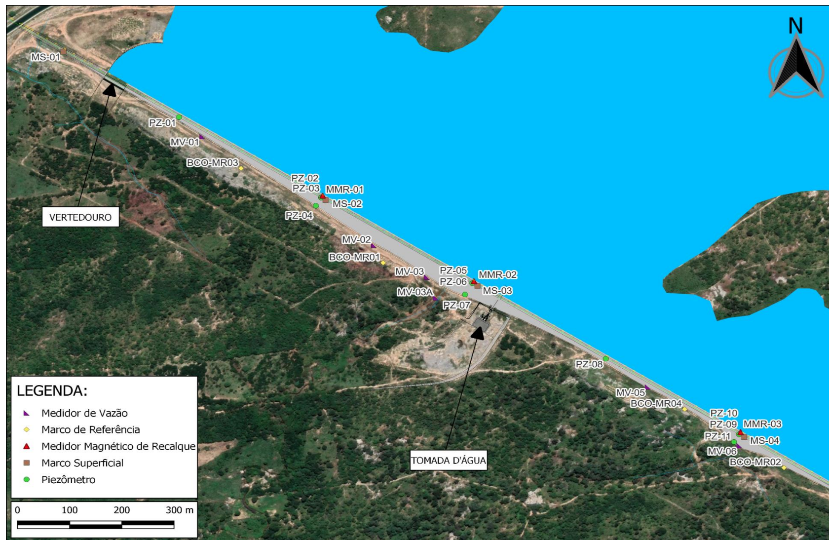
Figura 7.1 – Planta de localização da Instrumentação da Barragem Copiti. Fonte: Projeto As Built n.º 1303-DEP-2111-20-04-001-R00 modificado/Google Satélite DATUM SAD 69.
